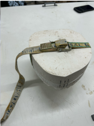
◀リリース(フォーム用離型剤)を塗り、フォームラテックスを流し入れ圧迫固定
